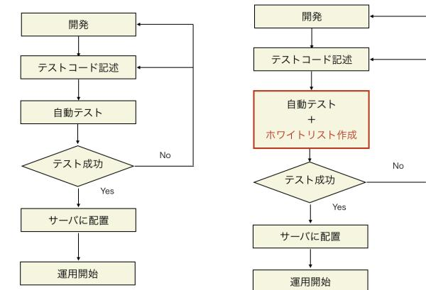
図1 自動テストを用いたWeb アプリケーションの開発プロセス
